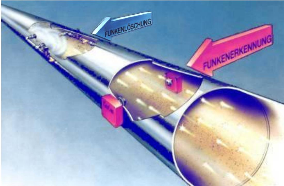
Funkenlöschanlagen erkennen Funken und löschen diese automatisch ab - Staubbrände und Explosionen werden vorbeugend verhindert
